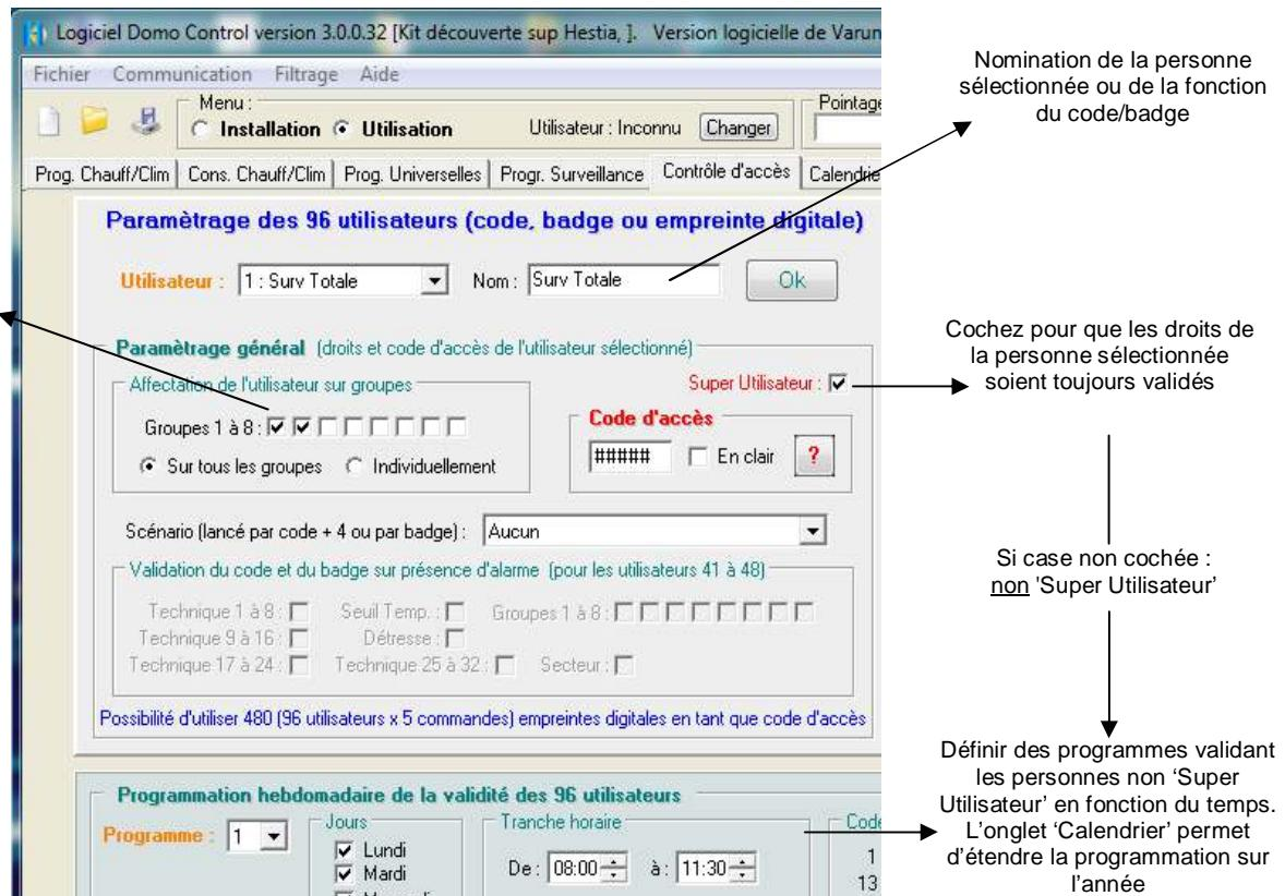
Les codes d'accès (96) se composent de 5 chiffres auxquels s'ajoute une commande fonction de l'action désirée :
