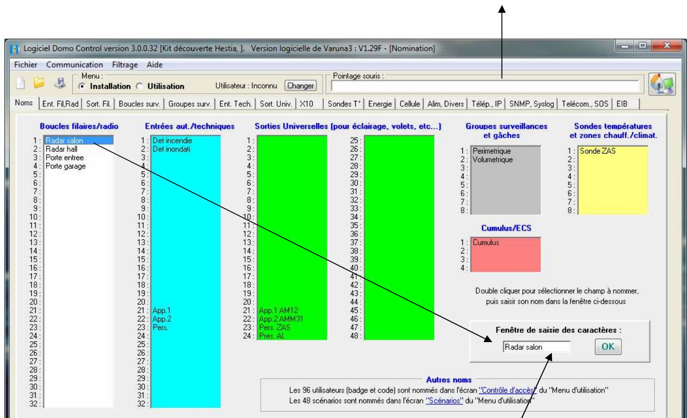
Cet onglet permet de nommer tous les objets domotiques utilisés (12 caractères maximum). Ces noms apparaîtront entre crochets où que vous soyez dans le logiciel afin de vous aider dans le paramétrage des différents onglets.
